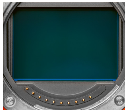
▲ Vollformatsensor der \alpha 7V , 35,9 \times 23,9 mm, ca. 35,7 Megapixel gesamt, ca. 33 MP davon bildgebend.
