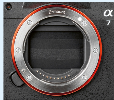
▲ Die Lamellen des mechanischen Verschlusses können den Bildsensor bei ausgeschalteter \alpha 7V verdecken.
