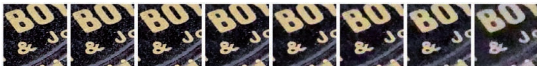
▲ JPEG-Bild mit kamerainterner Rauschunterdrückung (ISO 200, 400, 800, 1600, 3200, 6400, 12800 und 25600).
