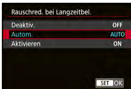
Abbildung 4.8 Mit AUTO springt die Rauschreduzierung bei Langzeitbelichtungen automatisch an.
