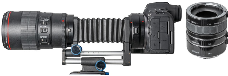
Abbildung 4.10: Makroobjektiv am Balgengerät, Tubuslänge ca. 125 mm (links); drei kombinierte Zwischenringe mit insgesamt 68 cm langem Tubus (rechts)
