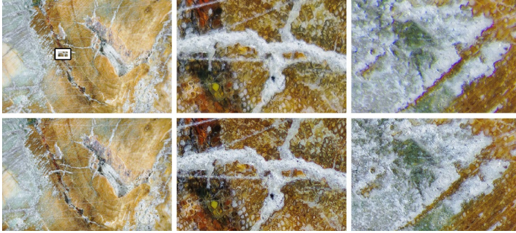
Abbildung 4.8: Voller Bildausschnitt mit markiertem Vergleichsausschnitt (links), fokussierte Bildstelle (Mitte) und Bildrand (rechts); obere Zeile: Weitwinkelobjektiv in Retrostellung, untere Reihe: Lupenobjektiv
