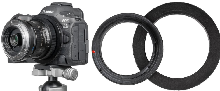
Abbildung 4.6: Kamera mit Weitwinkelobjektiv Laowa 15 mm f/4 1 : 1 Macro in Retrostellung (links) sowie Retroadapter (hier für Canon RF) und Adapterring (77 mm) für die Anbringung des Objektivs am Gewinde des Umkehradapters (rechts)
