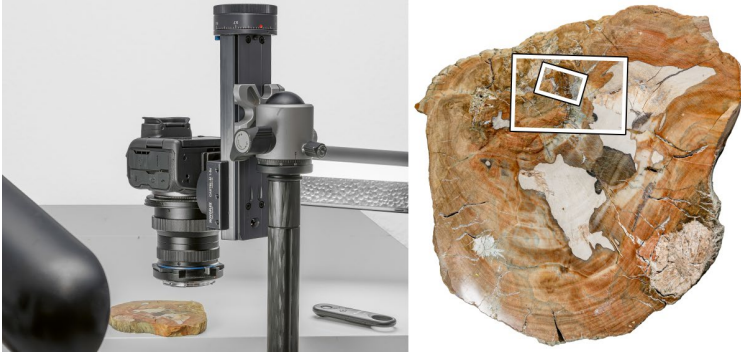
Abbildung 4.7: Aufnahmesituation mit dem Weitwinkelobjektiv in Retrostellung (links); das Motiv im Ganzen (rechts) mit markierten Ausschnitten von ca. 1 : 1 (Makroobjektiv) und ca. 2,5 : 1 (Weitwinkelobjektiv in Retrostellung)
