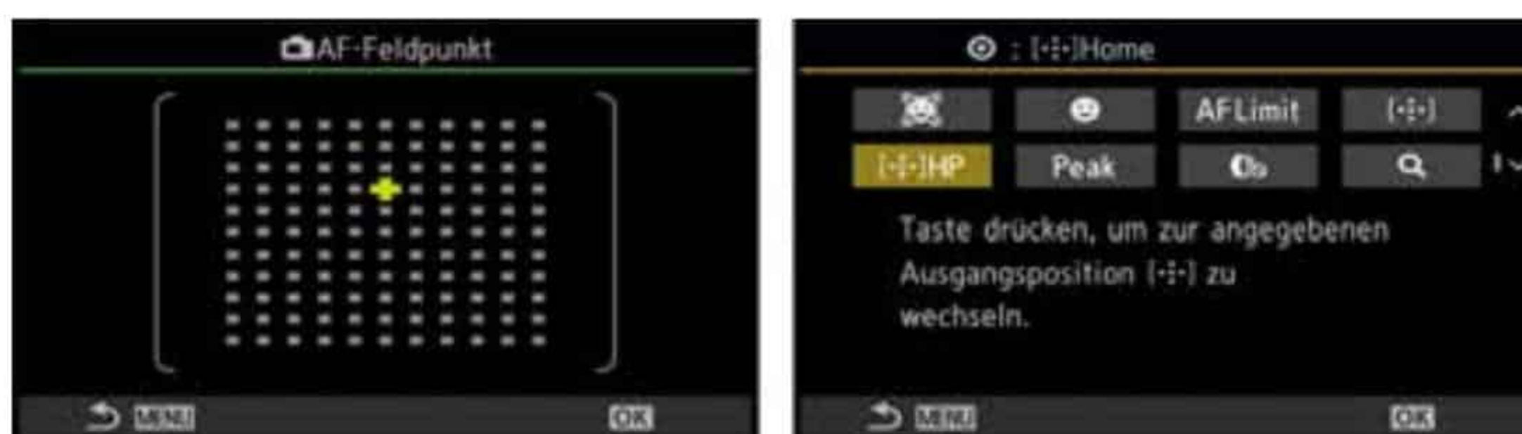
Abbildung 5.9 Position des AF-Feldpunkts für das Querformat wählen (links); Kamertaste mit HP (Home) belegen (rechts)
