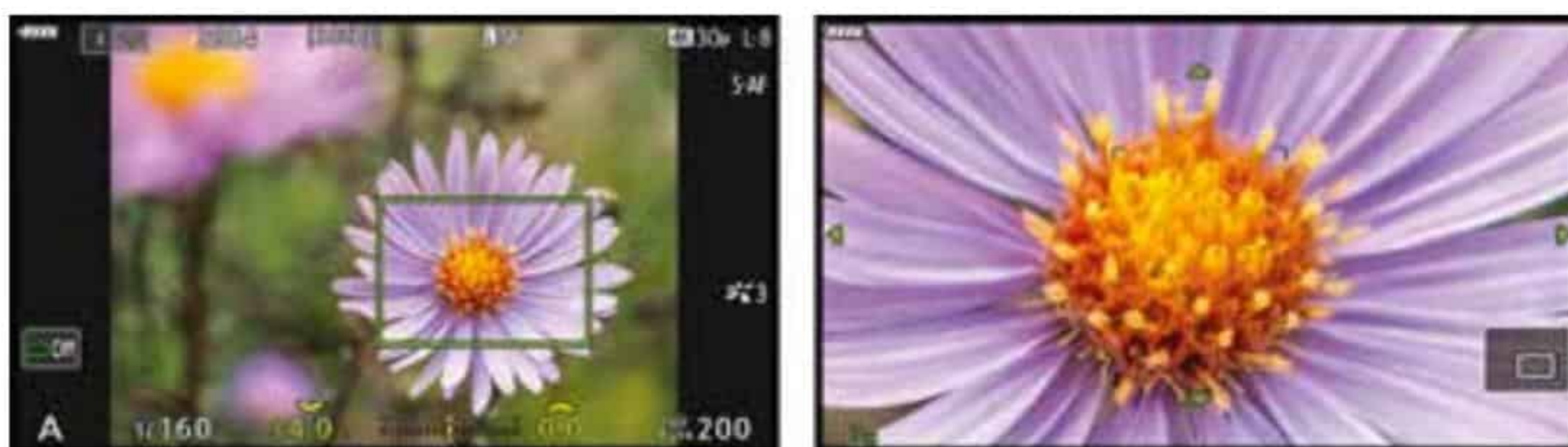
Abbildung 5.14 Zoomrahmen-AF positionieren und Zoomfaktor einstellen, hier 3x (links); aus der vergrößerten Ansicht heraus präzise scharfstellen (rechts)
