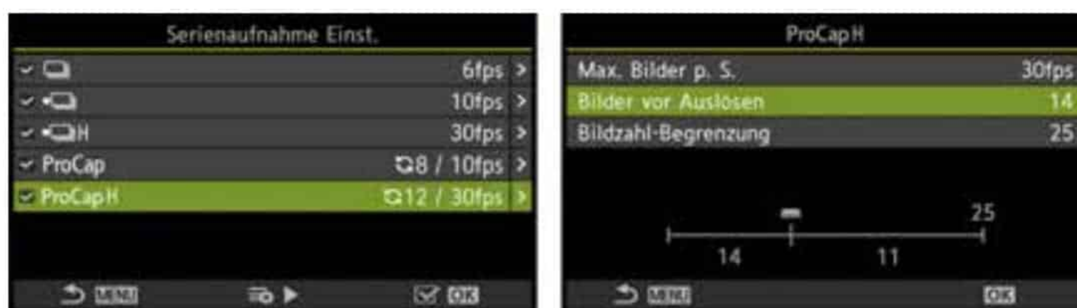
Abbildung 7.14 Einen Serienaufnahmemodus mit Voraufnahme ( ProCap ) einschalten (links) und die Detailsinstellungen treffen (rechts)
