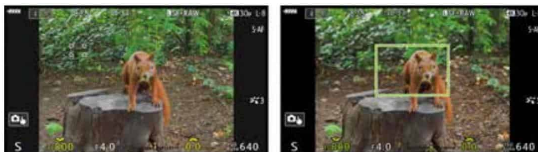
Abbildung 5.10 Vom AF-Feldmodus Single links (links) per Taste schnell auf den AF-Feldmodus Large oberhalb der Bildmitte umstellen (rechts)
