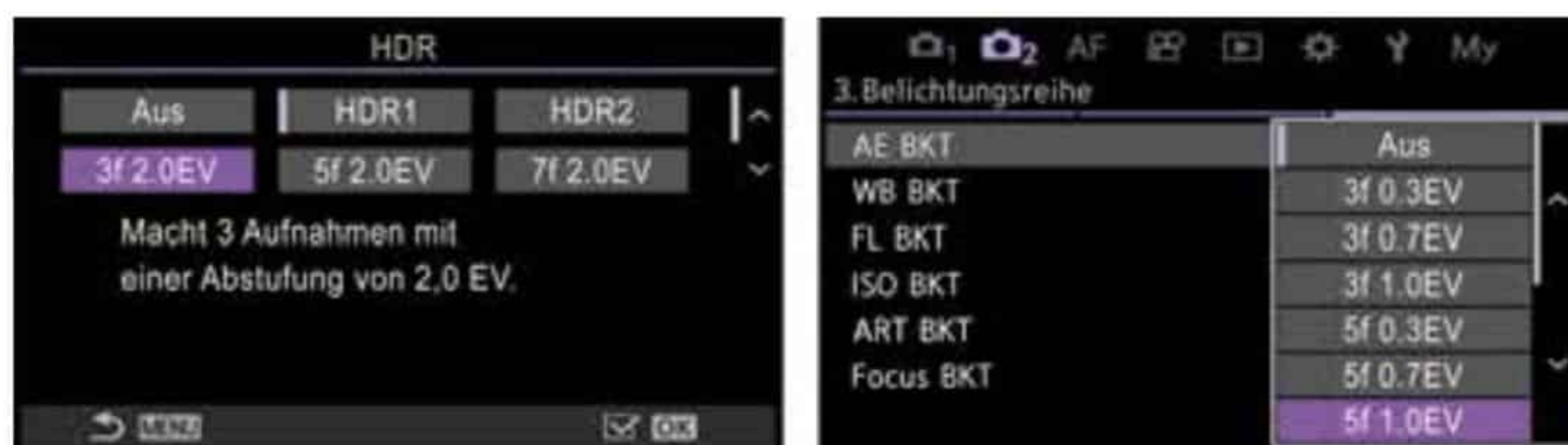
Abbildung 7.5 Belichtungsreihe mit dem Modus HDR (links) oder auf Basis der automatischen Belichtungsreihe AE BKT anfertigen (rechts)
