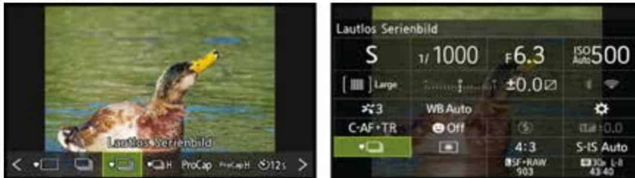
Abbildung 7.11 Serienaufnahme nach Drücken der Betriebsarttaste wählen (links) oder im Schnellmenü einstellen (rechts)
