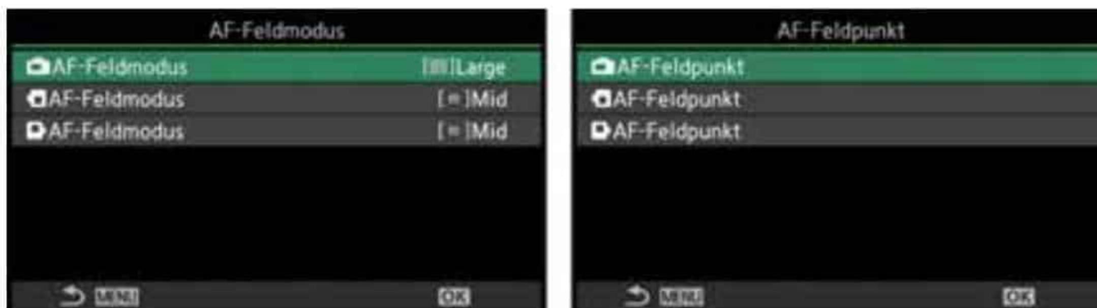
Abbildung 5.8 AF-Feldmodus je nach Kameraorientierung auswählen (links); Voreinstellungen für den AF-Feldpunkt (rechts)
