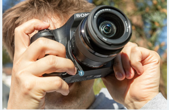
Kontrolle der zu erwartenden Schärfentiefe mit der Schärfentiefe-Kontrolltaste ①
