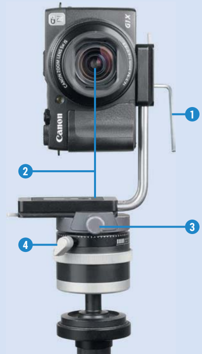
▲ G1 X Mark II auf einem L-Winkel: Inbus-Schlüssel zum Lösen und Drehen der Kamera ①, Objektivmitte auf Höhe der Stativkopfmittle ②, Schnellkupplung ③, Hebel für Panoramadrehung ④.
