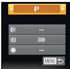
◀ Einstellung der Zoomstufen (ZOOM) mit der gestuften Ringsteuerung und Wahl des Blendenwerts im Modus Av bzw. der Belichtungszeit im Modus Tv mit dem Einstellungs-Wahlrad .
