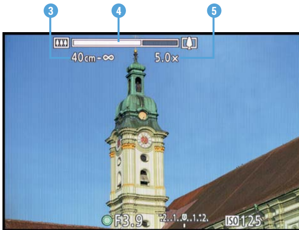
▲ Beim Betätigen des Zoomreglers werden der Fokussierbereich 3 und der Zoombalken 4 stets eingeblendet.
