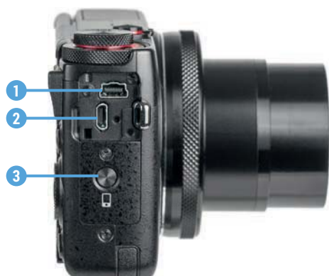
▲ Anschlussbuchsen auf der rechten Kameraseite
