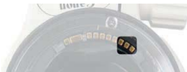
▲ Canon-L-Objektiv mit den drei Zusatzkontakten für Telekonverter
