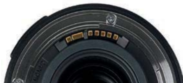
▲ EF-Objektivkontakte (Nummer 2 und 3 sind miteinander verschmolzen)
