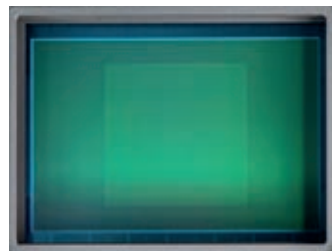
▲ X-Trans™ CMOS III Sensor der X-T20 (23,6 × 15,6 mm, APS-C-Format).
