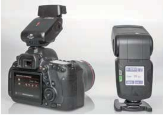
▲ Speedlite 270EX II im manuellen Blitzmodus mit 1/64 Leistung als Master und Metz mecablitz 52 AF-1 als entfesselter Servo-Blitz mit manueller Leistung 1/4.
