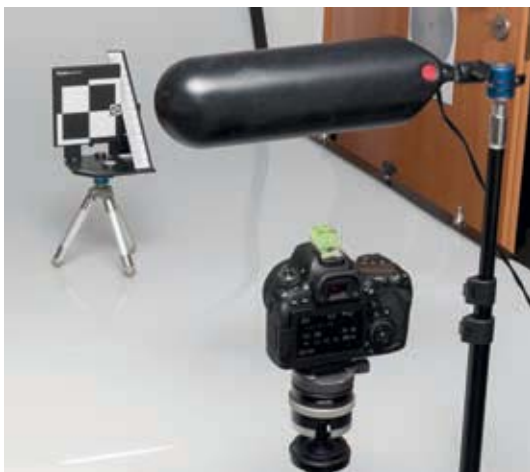
▲ Testaufbau, hier mit dem SpyderLENSCAL und einer Blitzschuh-Wasserwaage auf der EOS 6D Mark II.
