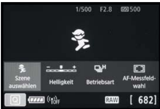
▲ Der Modus Kinder arbeitet mit kurzen Belichtungszeiten zum Einfrieren von Bewegungen.
