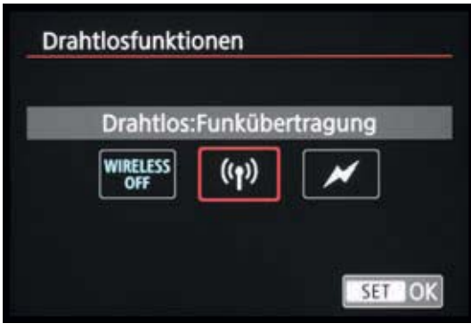
▲ Funkgesteuerte Drahtlosfunktion für funkfähige Master-Blitzgeräte und Funktransmitter.
