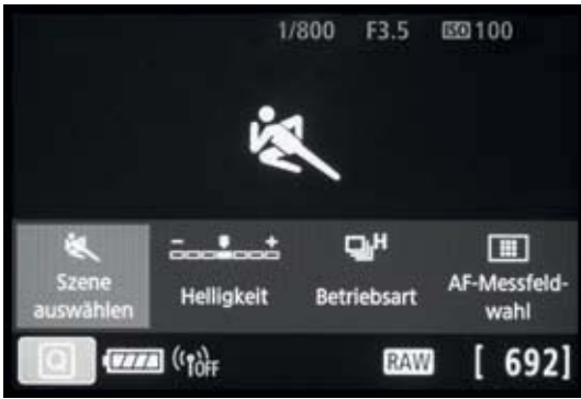
▲ Zum Einfrieren von Bewegungen verwendet der Sportmodus kurze Belichtungszeiten (hier 1/800 Sek.).
