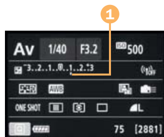
▲ Belichtungskorrektur von +1 Stufe.
