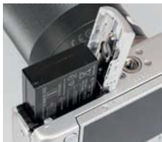
▲ In der EOS M100 werden Lithium-Ionen-Akkus vom Typ LP-E12 (7,2 V, 875 mAh) verwendet.
