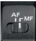
▲ EF-/EF-S-Objektive auf Manuellen Fokus umschalten.
