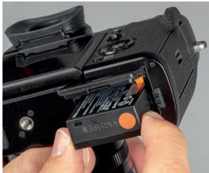
▲ Der Akku wird so in das Fach eingeschoben, dass der orangefarbene Punkt rechts außen lokalisiert ist.
