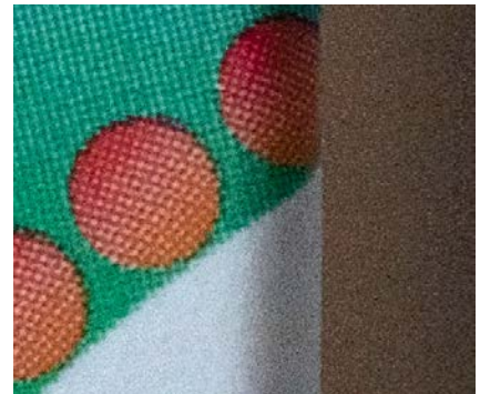
▲ RAW komprimiert. Eine Pappschachtel wurde um fünf Stufen unterbelichtet aufgenommen und in Lightroom um fünf Stufen wieder aufgehellt.
