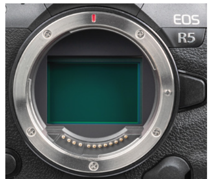
▲ CMOS-Sensor der EOS R5 mit integriertem Dual Pixel CMOS AF.
