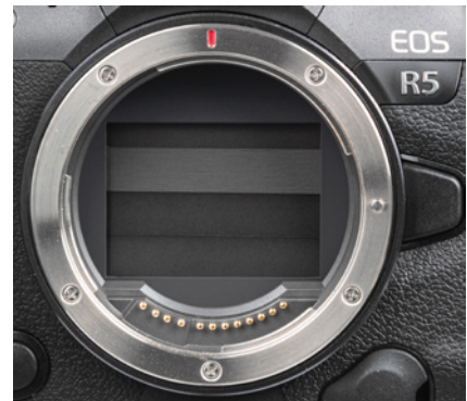
▲ Das RF-Bajonett hat zwölf elektrische Kontakte. Der Sensor wird zum Schutz vor Staub und Beschädigung vom Schlitzverschluss abgedeckt, sobald die Kamera ausgeschaltet wird.
