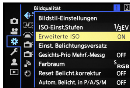
▲ ISO-Einstellstufen (1/3 oder 1 EV) und Erweiterte ISO, um L.50 bis L.80 nutzen zu können.
