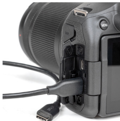
▲ Der USB-Anschluss der EOS R7 ist mit dem Standard SuperSpeed Plus USB 3.2 Gen 2 USB Typ C ausgestattet.
