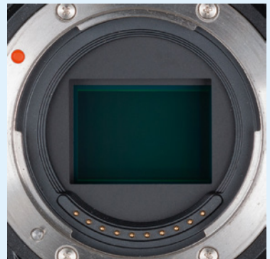
▲ Der X-Trans CMOS 5 HR Sensor der X-T5 hat eine Bildaufnahmeffläche von 23,5 \times 15,7 mm im Format APS-C (Cropfaktor gegenüber Vollformat ca. 1,5).
