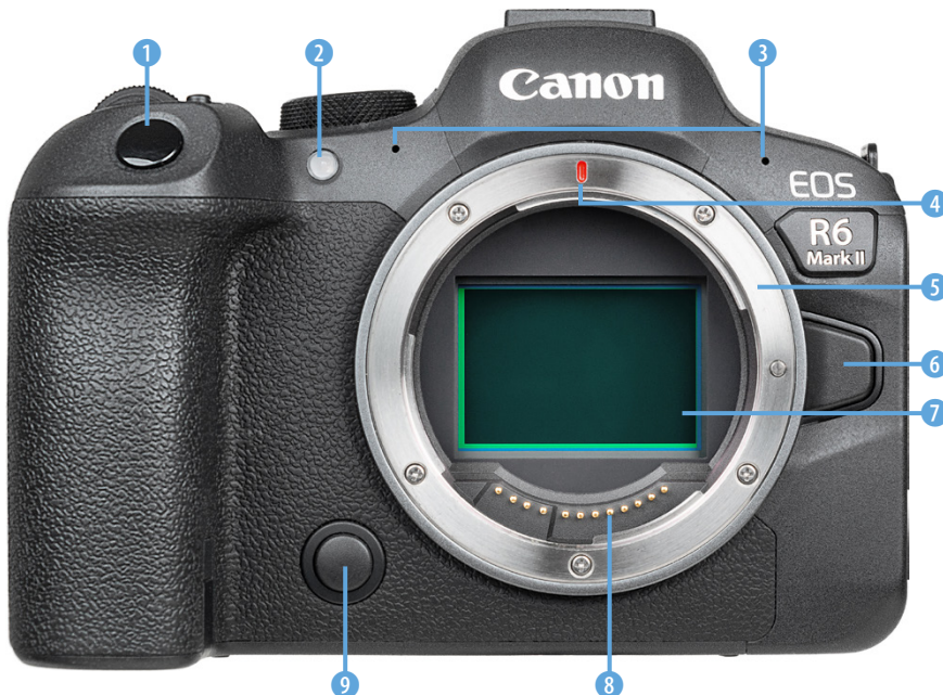
▲ Bedienungselemente auf der Vorderseite der EOS R6 Mark II.
