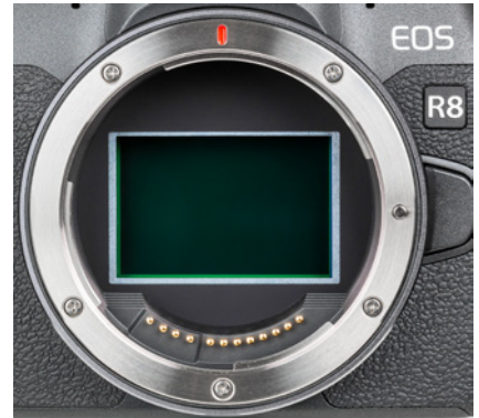
▲ CMOS-Sensor umrahmt vom RF-Bajonett mit zwölf Kontakten für die Kommunikation zwischen Objektiv und Gehäuse.
