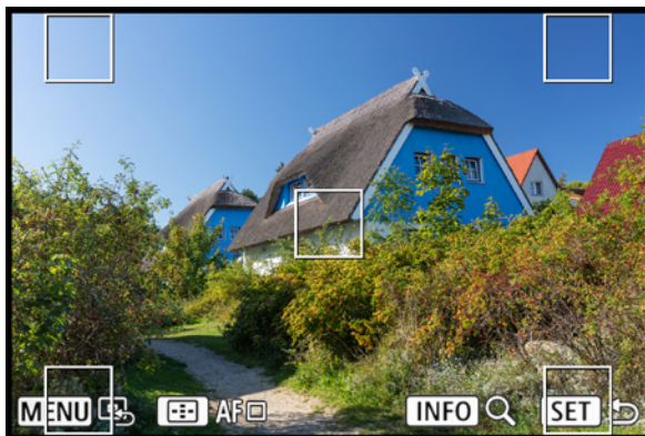
▲ Darstellung der vier Außenpositionen und der Mittelposition des Einzelfeld AF.
