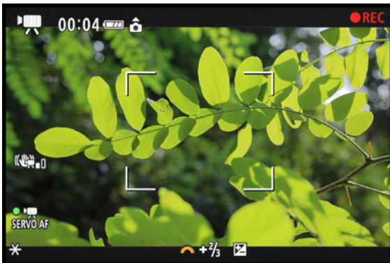
▲ Laufende Aufnahme im Modus automatische Videobelichtung, hier mit gespeicherter Belichtung und einer Belichtungskorrektur um +2/3 EV.
