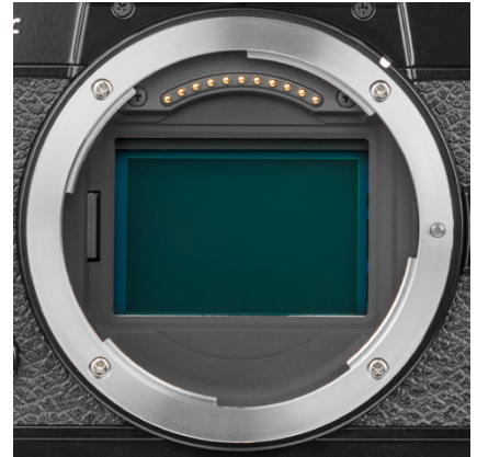
▲ CMOS-Sensor mit 24,5 bildgebenden Megapixeln auf einer Fläche von 35,9 × 23,9 mm (Vollformat/FX-Format).
