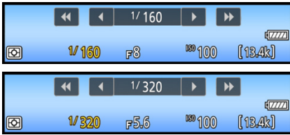
▲ Wird die Belichtungszeit bei festem ISO-Wert um eine Stufe verkürzt, verringert sich der Blendenwert ebenfalls um eine Stufe, und umgekehrt. So wird eine konstante Bildhelligkeit garantiert.
