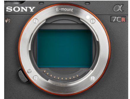
▲ Der Vollformatsensor der α7CR, 35,7 × 23,8 mm mit ca. 62,5 Megapixeln gesamt, ca. 61 MP davon sind bildgebend.
