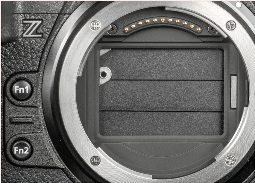
Abbildung 1.3 Der Sensorschutz kann das Eindringen von Staub beim Objektivwechsel verringern.
