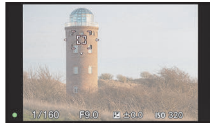
Abbildung 5.6 Findet die Kamera innerhalb des kleineren Fokussierrahmens keinen Schärfepunkt, weitet sie das Feld bei Einstellung von Erweit. Flexible Spot bis zum äußeren Rahmen aus.
