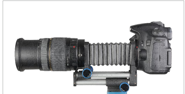
↘ Abbildungsmaßstab 1,6 : 1 mit ausgezogenem Balgengerät 75 mm | f/5,6 | 13s | ISO 100 | -0,7 EV | Stativ
