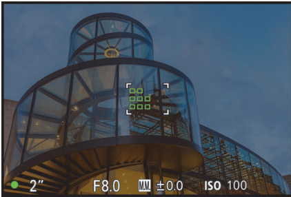
Abbildung 4.4 Wählen Sie das Fokusfeld Mitte-Fix , wenn Sie die Schärfe zwischenspeichern und anschließend den Bildausschnitt verändern möchten.
