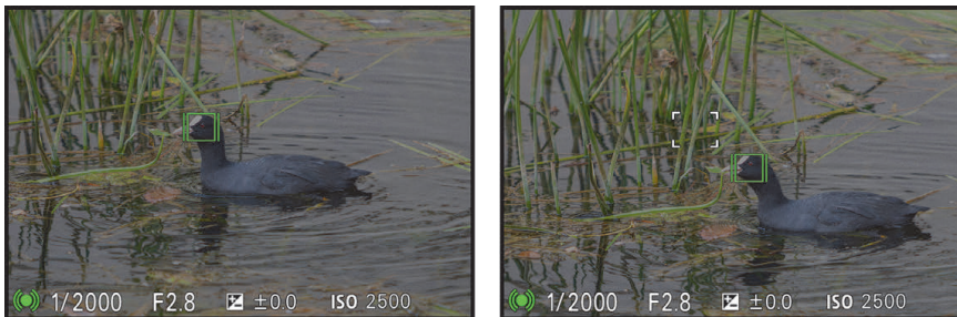
Abbildung 4.33 Verfolgung starten, hier mit Tracking: Spot L (links); initiales weißes AF-Feld und grünes Trackingfeld auf dem Motiv (rechts)
