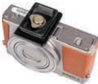
▲ Mit verdreht angebrachter Stativplatte ließ sich der Akkufachdeckel weiterhin öffnen.
