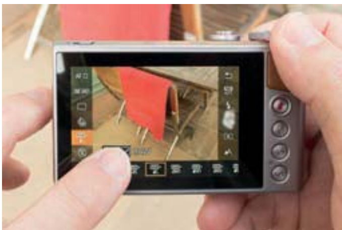
▲ Auswahl der Bildgröße und Zuschalten des RAW-Formats über die Touch-Bedienung.
