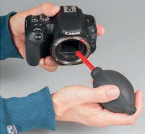
▲ Berührungslose Sensorreinigung mit dem Blasebalg.
