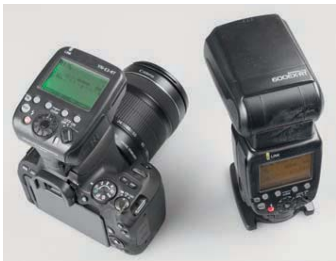
◀ Speedlite Transmitter YN-E3-RT an der Canon EOS 200D gekoppelt via Funk mit dem Speedlite 600EX-RT.
