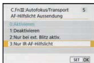
▲ Einstellungsmöglichkeiten der AF-Hilfslicht Aussendung.
