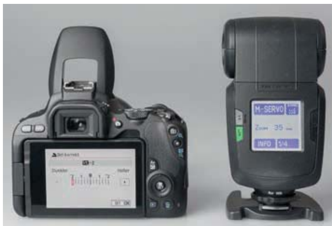
◀ Interner Blitz mit Blitzbelichtungskorrektur –2 und Metz mecablitz 52 AF-1 als entfesselter Servo-Blitz mit manueller Leistung \frac{1}{4} .
