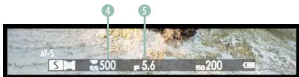
▲ Nach dem Anpassen der Belichtungszeit im Modus S können Sie den automatisch gewählten Blendenwert sehen, indem Sie den Auslöser auf den ersten Druckpunkt herunterdrücken.
