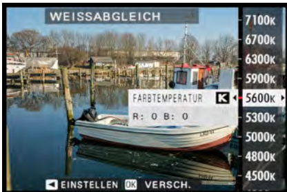
▲ Einstellen des Weißabgleichs FARBTEMPERATUR über das Menü und Auswahl des Kelvinwerts, hier 5600 K.
