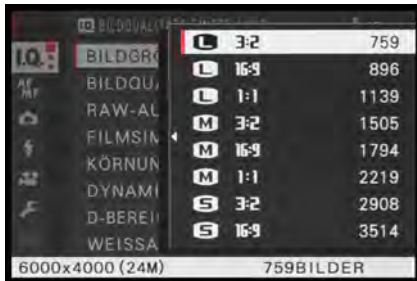
▲ Auswahl von JPEG-Bildgröße und Seitenverhältnis. Die Anzahl möglicher Bilder wird rechts mit angegeben.
