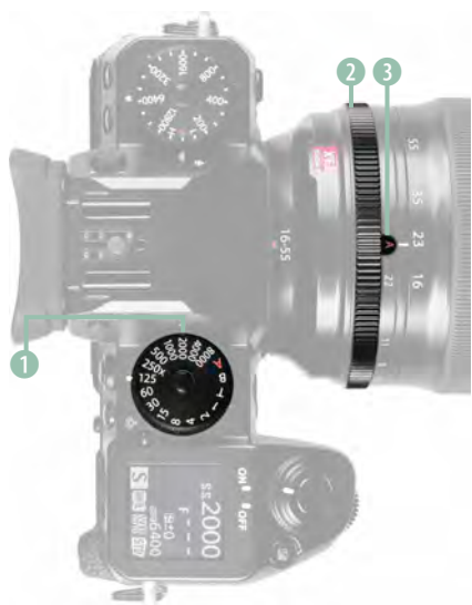
▲ Einstellen der Zeitvorwahl (S) mit einer Belichtungszeit von 1/2000 Sek.
